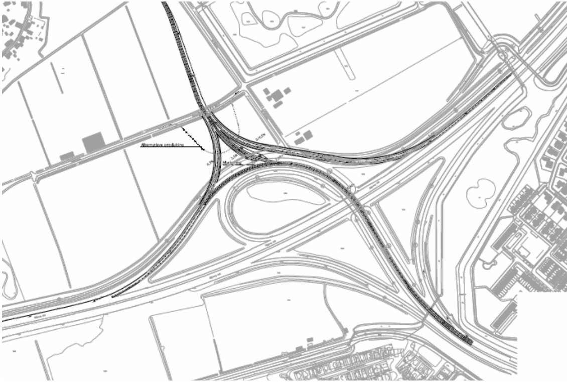
Figuur 1.3 Voorstel vormgeving voorlopige aansluiting Oostelijke Randweg
